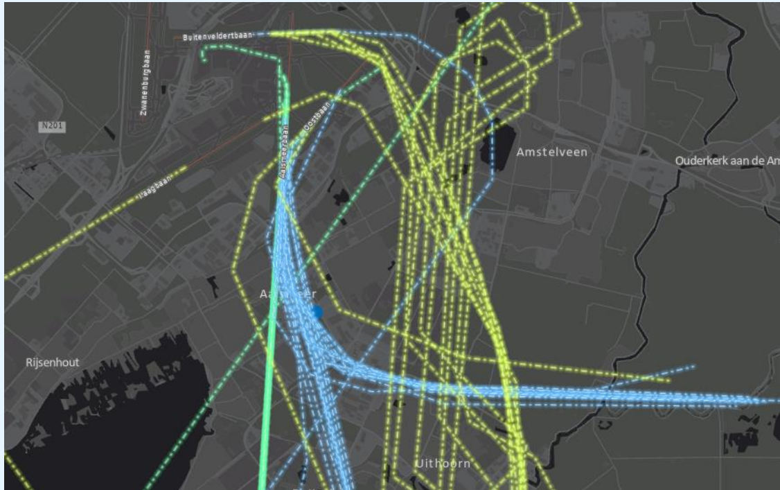
figuur B1.4: selectie van de geregistreerde vluchten bij meetpunt Hornweg. Groen: Landend 60-70 dB(A), Blauw: Stijgend 70-85 dB(A) en Geel: stijgend 55-65 dB(A)
